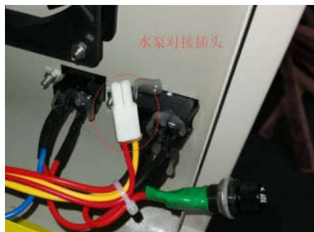
图 2-4：右侧机壳内的“水泵插口”示意图
